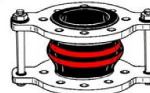
С фланцами с ограничителями длины типа ZS
