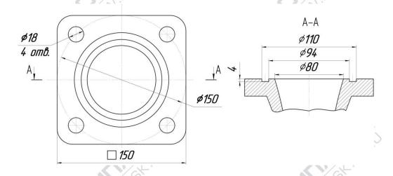
Рис. 4 Присоединительные размеры патрубков насоса.
