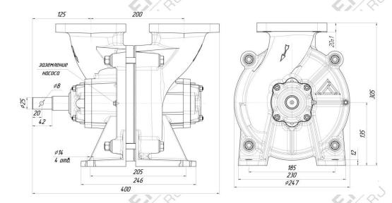
Рис. 3. Габаритные и присоединительные размеры насосов левого вращения.
