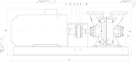
Рис. 5 Агрегат на сварной стальной плите
