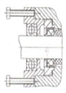
Рис 11. Съемник.
