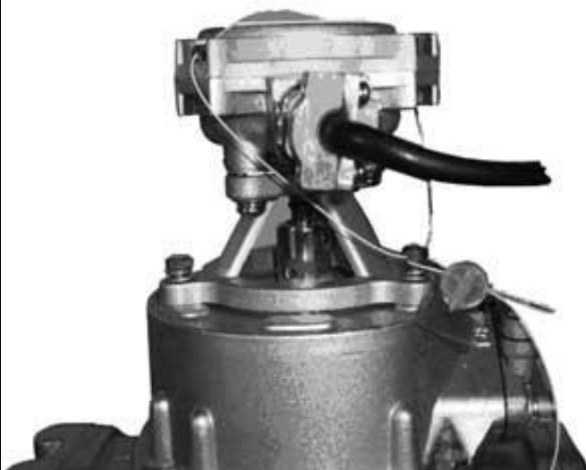
Рис.2. Пломбировка датчика расхода топлива
