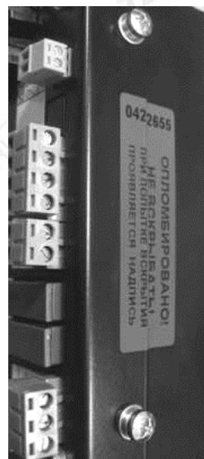
Рис.4. Пломбировка корпуса блока управления
