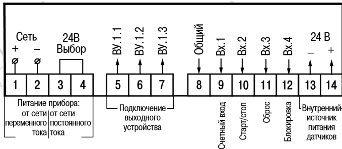
Рисунок 5.1 – Назначение контактов клеммника
