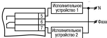
Рисунок 5.5 – Схема подключения нагрузки к ВУ типа Р
