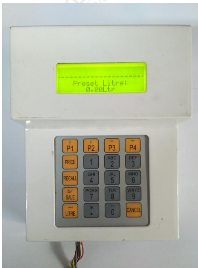
Рисунок 15: Пульт для настройки колонки Sanki
