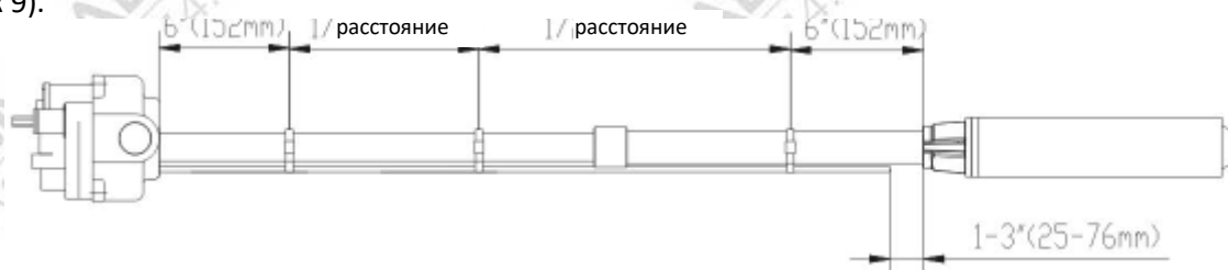
Рисунок 9: Крепление трубопровода обратной линии к насосу
