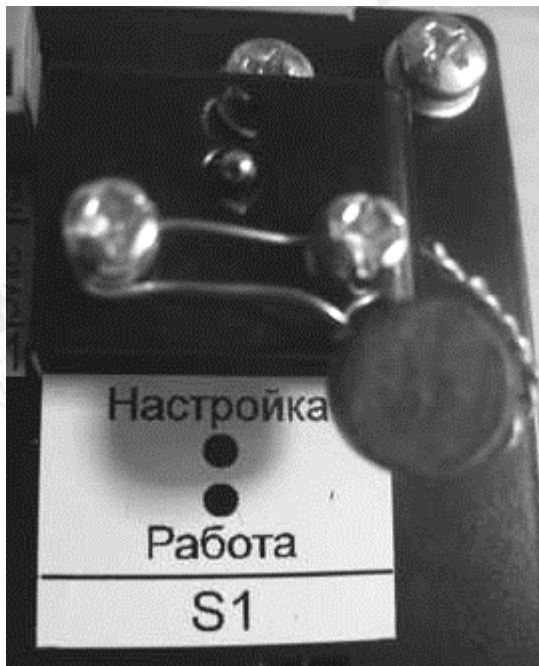
Рис.3. Пломбировка тумблера «Настройка/Работа» блока управления
