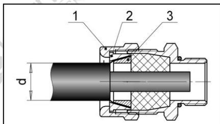
Фиксация брони кабеля осуществляется между втулками 2 и 3 при наворачивании втулки резьбовой 1 (изоляцию брони на этом участке удалить). Максимальный диаметр брони  $d=16$  мм.
