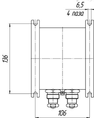
Рисунок 1.8 - Вариант крепления МС-К-500-3-ВЗ при помощи крепежных пластин (вид снизу)
