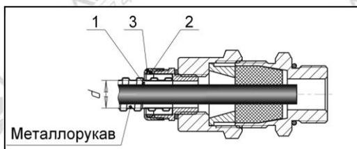
Навернуть металлорукав на втулку 1, имеющую диаметр  $d=10$  мм (УКМ10),  $d=15$  мм (УКМ15) и  $d=20$  мм (УКМ20). Затем установить уплотнительное кольцо 2, и навернуть резьбовую втулку 3.
