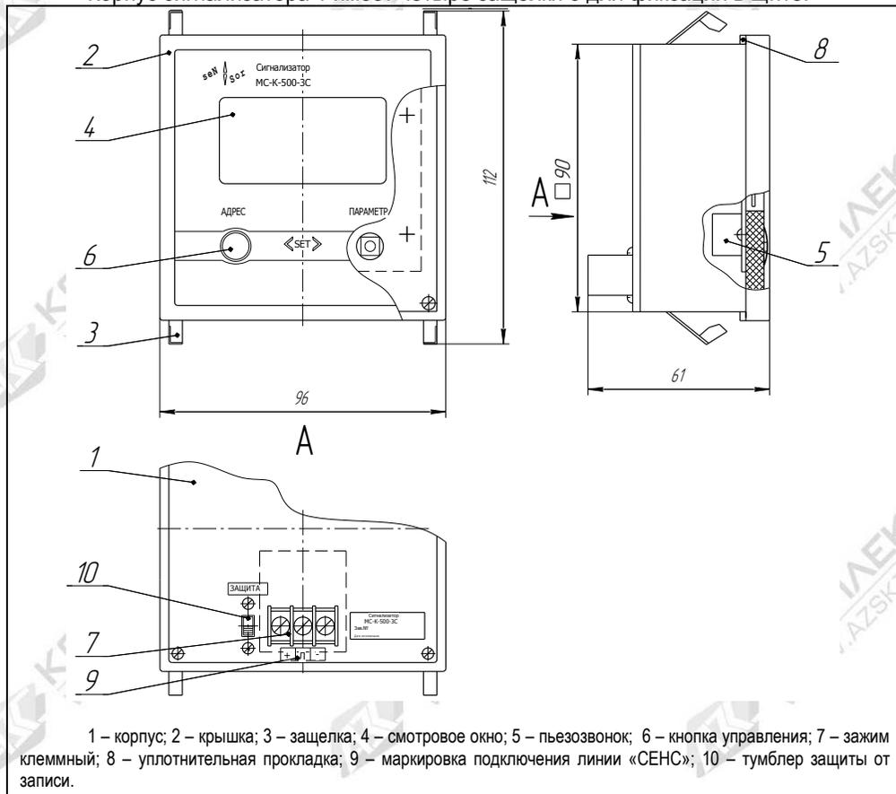
1 – корпус; 2 – крышка; 3 – защелка; 4 – смотровое окно; 5 – пьезозвонок; 6 – кнопка управления; 7 – зажим клеммный; 8 – уплотнительная прокладка; 9 – маркировка подключения линии «СЕНС»; 10 – тумблер защиты от записи.
