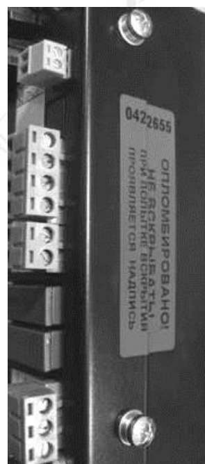
Рис.4. Пломбировка корпуса блока управления
