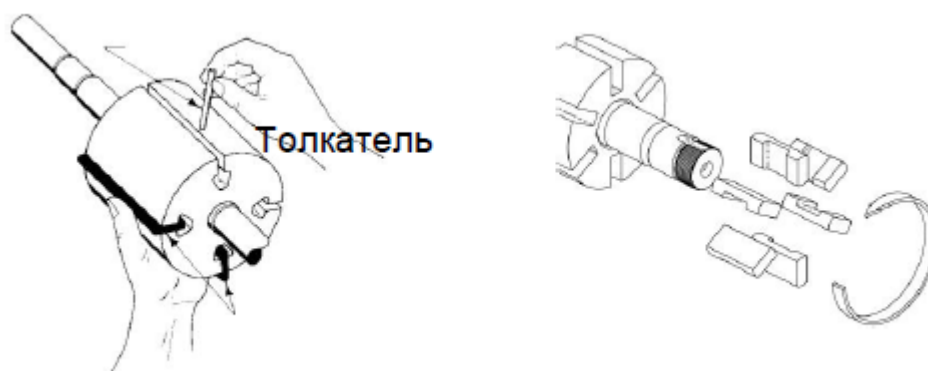
Схема установки принципиальная; подходит для всех типов шиберных насосов.
