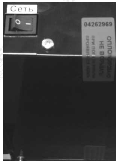
Рис.4. Пломбировка корпуса блока управления
