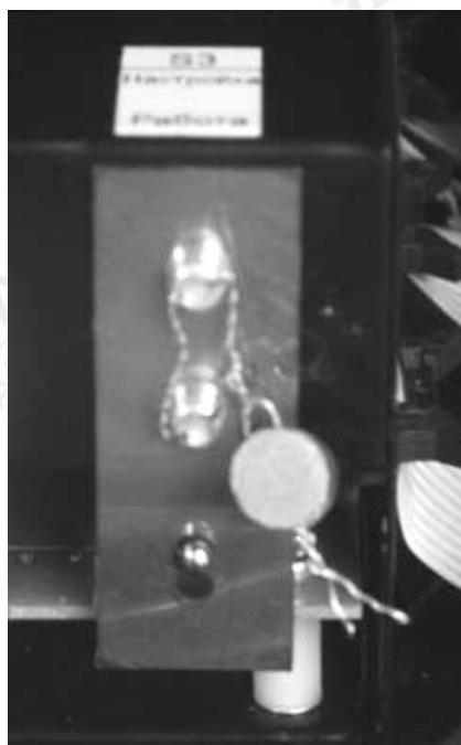
Рис.3. Пломбировка тумблера «Настройка/Работа» блока управления
