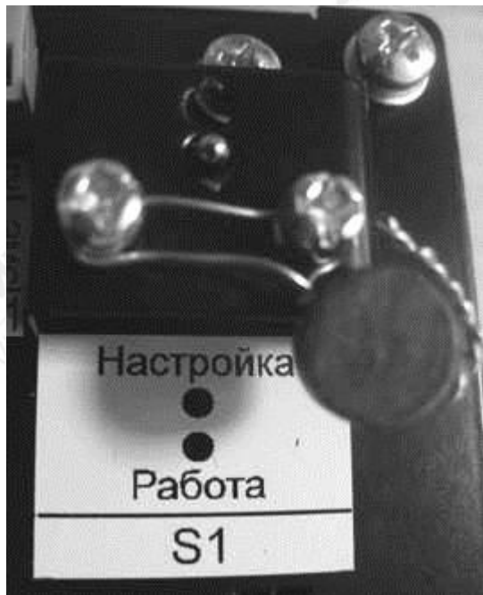
Рис.3. Пломбировка тумблера «Настройка/Работа» блока управления
