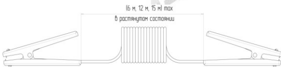
Рисунок 5а – Заземляющий проводник УЗА-С
