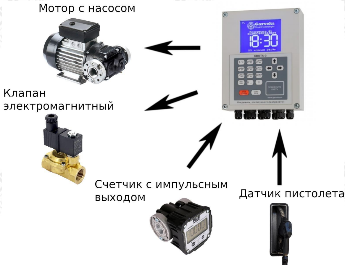
Рисунок 2: Конфигурация оборудования для одного поста
