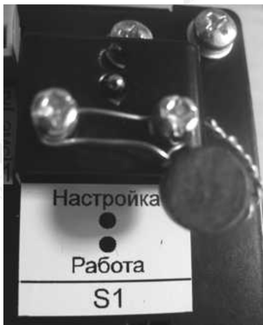
Рис.3. Пломбировка тумблера «Настройка/Работа» блока управления
