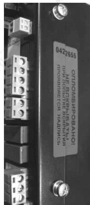
Рис.4. Пломбировка корпуса блока управления
