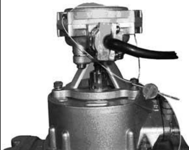
Рис.2. Пломбировка датчика расхода топлива
