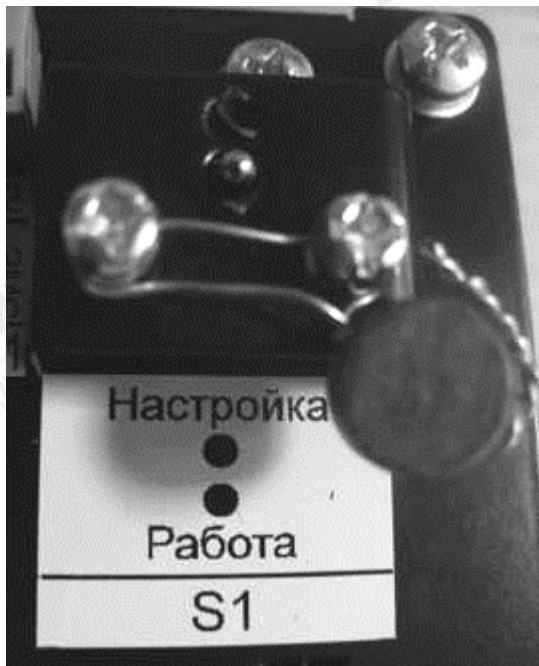
Рис.3. Пломбировка тумблера «Настройка/Работа» блока управления
