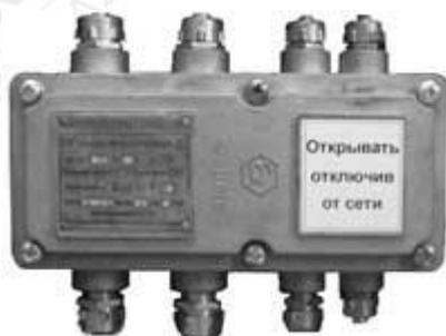
Коробка распределительная представляет собой металлический корпус, в котором установлены клеммы для подключения кабелей от узлов электрооборудования колонки. Кабели заводятся в распределительную коробку через герметичные взрывозащищённые кабельные вводы.
