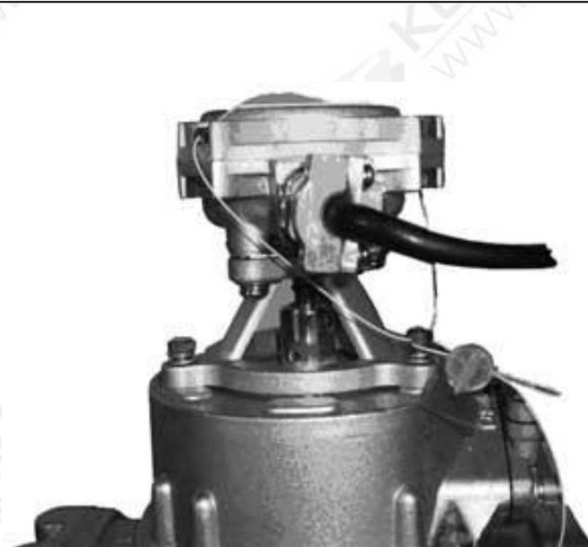
Рис.2. Пломбировка датчика расхода топлива
