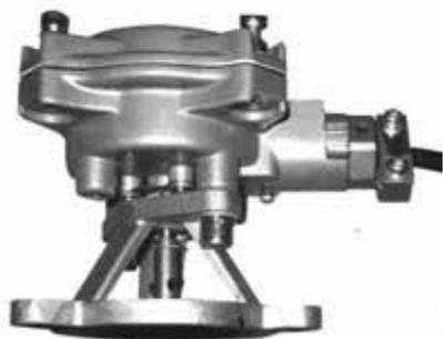
Датчик расхода топлива применяется для преобразования механического вращения вала измерителя объема в количество последовательных электрических импульсов, используя при этом оптический метод. Валу датчика импульсов передается вращение от измерителя объема. На валу закреплён диск с прорезями, при вращении которого формируются два импульсных сигнала, со разницей по фазе 90°. Количество формируемых датчиком импульсов пропорционально
