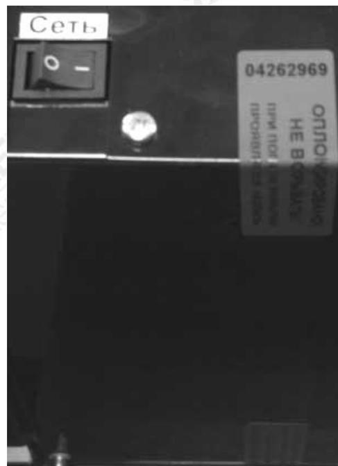
Рис.4. Пломбировка корпуса блока управления
