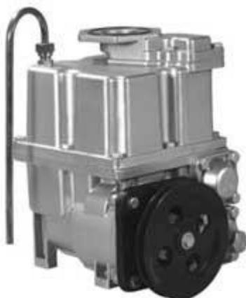
При работе моноблока на его входе создается разрежение и топливо из резервуара через фильтр и обратный клапан поступает в насос, из которого под давлением подается в газоотделитель, закручиваясь в его цилиндрическом корпусе. Под действием центробежных сил пузырьки воздуха вытесняются к центру газоотделителя и отводятся в поплавковую камеру. Топливо, поступающее вместе с пузырьками воздуха в поплавковую камеру,
