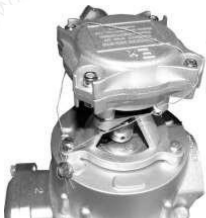
Рисунок 5.2 - Пломбирование генератора импульсов
