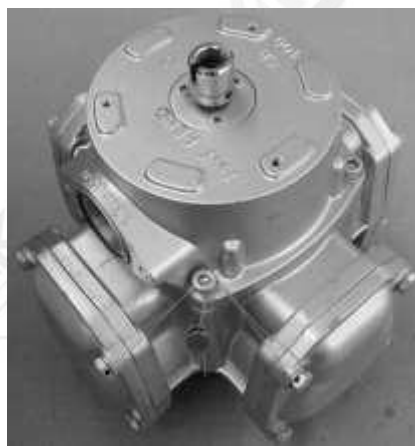
Рисунок 5.1 - Пломбирование объемного счетчика жидкости типа RSJ-50
