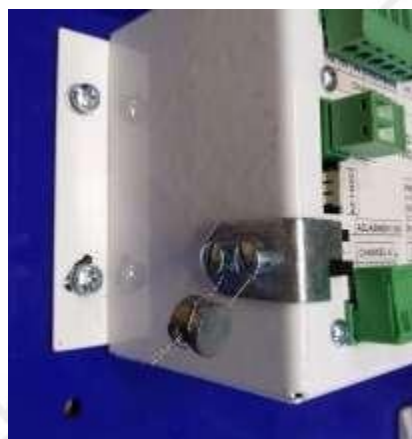
Рисунок 5.3 - Пломбировка отсчетного устройства ЭКО
